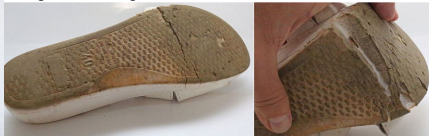
← durchgelaufen/durchgetragen – teilweise aufgelöstes und gerissenes Material
